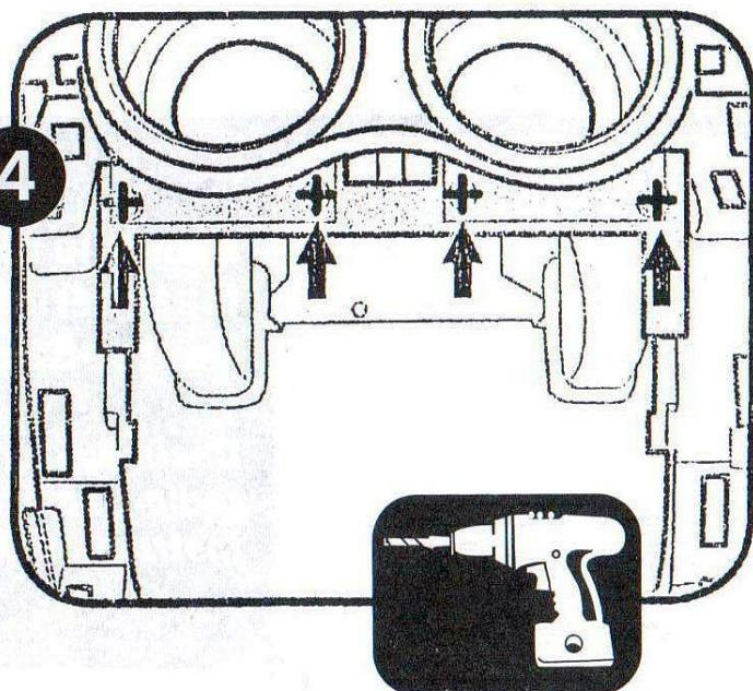
Utilizzando la dima di supporto,forare nei 4 punti indicati nella fig. 4 (foro  $\varnothing$  4 mm)
